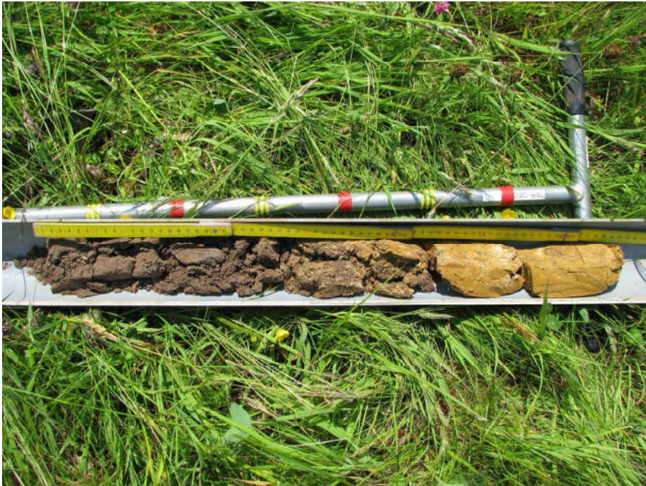
Photographie 4 – Vue du carottage pour le sondage pédologique P3 (L. Brunet)
